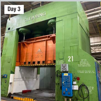
1250 Ton Clearing Model BD4-1250-144-84 Double Action SSDC Press
