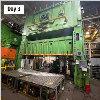
2500 Ton Clearing F2-2500-232, SSDC Press, 233" Bed area
